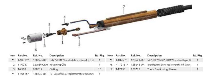
THERMACUT® REPLACEMENT PARTS SUITABLE FOR POWERMAX® 1000 / POWERMAX® 1250 T60<sup>TM</sup>/T80<sup>TM</sup> HAND TORCH
